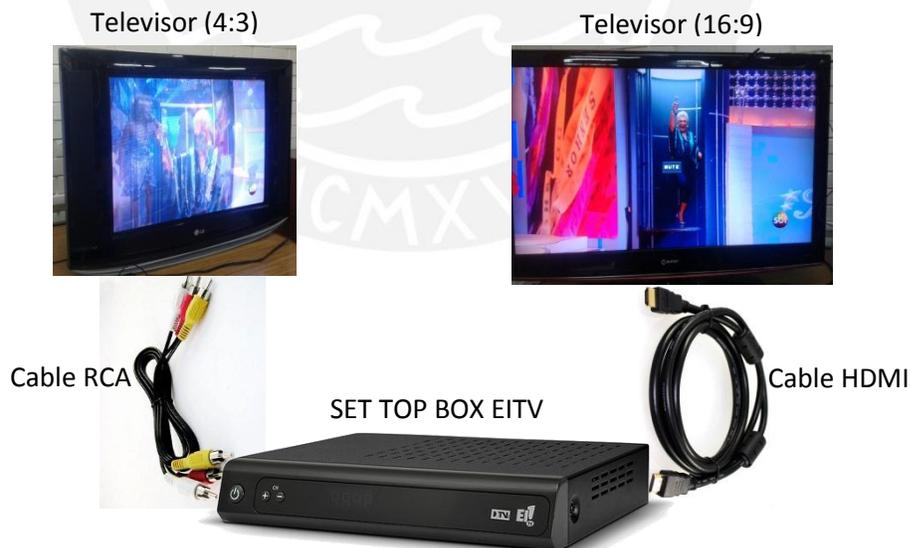
**Figura 4-11 Conexión set top box EITV**
