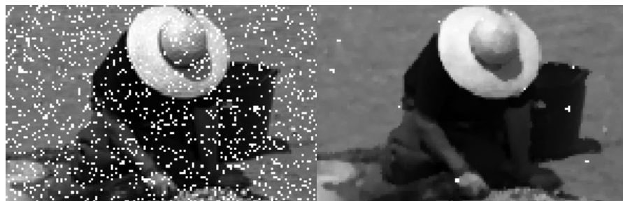
Figura 2.13 (izquierda) imagen afectada por ruido (derecha) imagen filtrada
