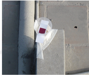
Figura 2.2: Montaje de detectores LR-115 tipoII
