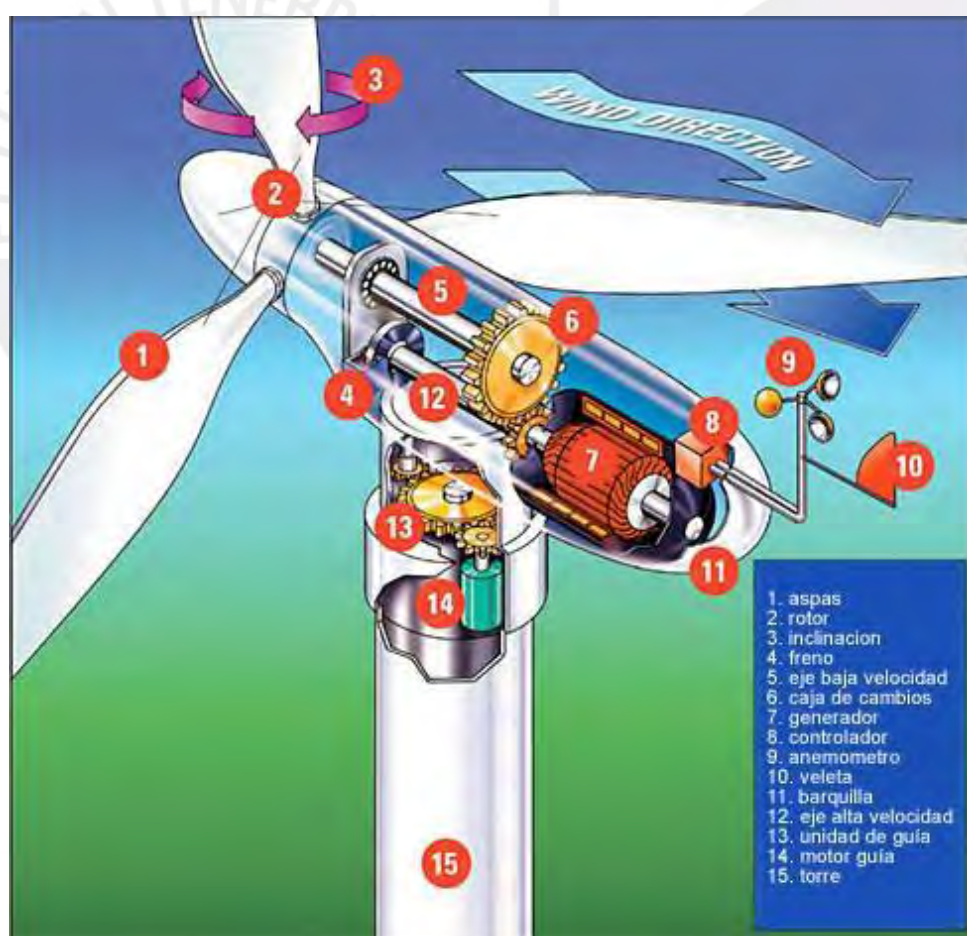
Figura 26. Partes de una turbina eólica.
