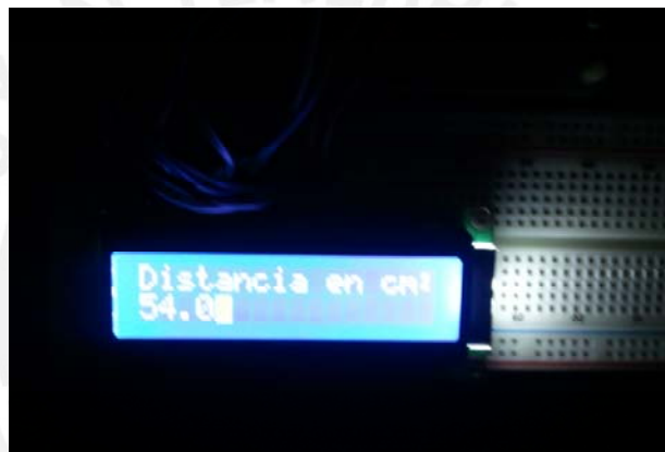
Figura 59: Distancia mostrada de 54.0 vs Distancia real de 53.6
