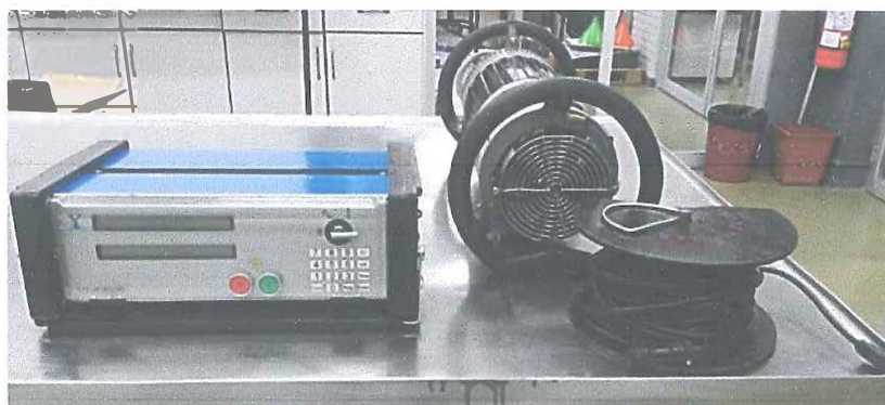
Foto 1.1. Unidad de control de un equipo de rayos X.
