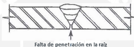
Figura 2.4. Falta de penetración.
