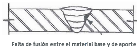
Figura 2.3. Falta de fusión.
