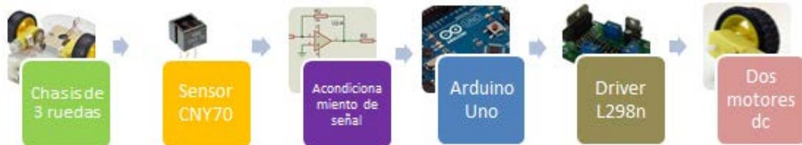
Figura 3.31: Diagrama de bloques del Módulo Electrónico para Robot seguidor de línea.
