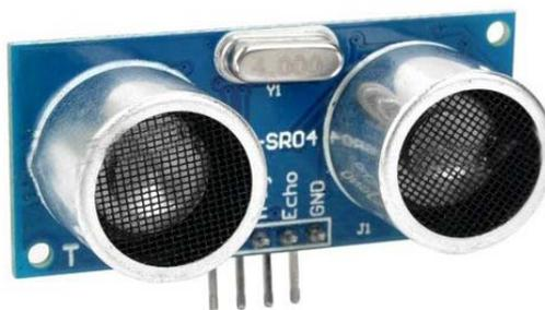
Figura 3.23: Sensor de distancia Arduino HC-SR04[17]
