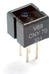
Figura 3.32: Sensor óptico reflectante CNY70 [15]
