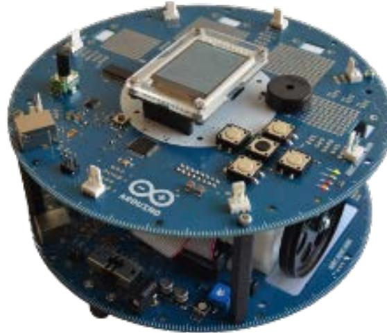
Figura 2.4: Arduino robot especialmente diseñado para robótica educativa [8]
