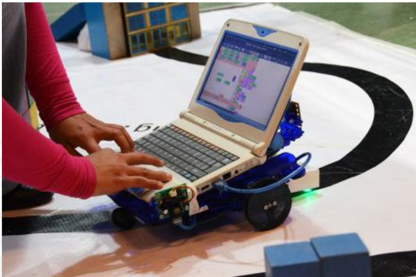
Figura 2.6: Robot butiá realizando la labor de un seguidor de línea [3]
