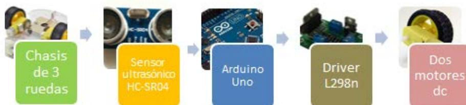
Figura 3.20: Diagrama de bloques del Módulo Electrónico para Robot esquivo obstáculos.
