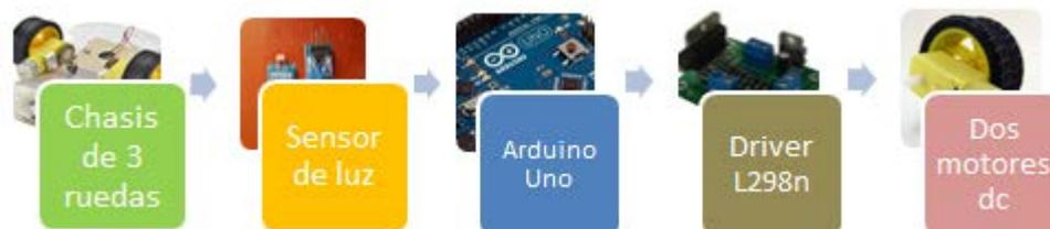
Figura 3.41: Diagrama de bloques del Módulo Electrónico para Robot seguidor de luz.
