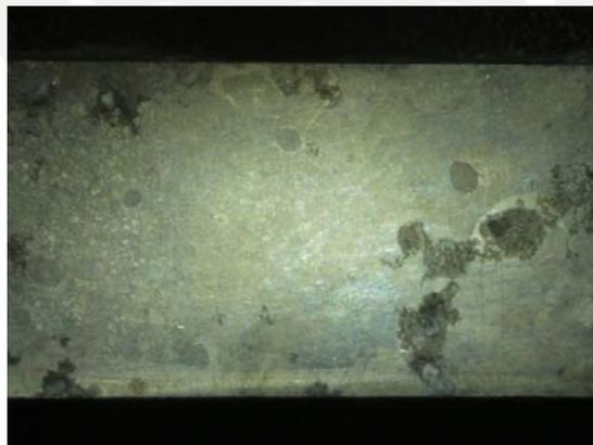
**Figura 3.6.** Fotografía de una de las superficies de la aleación AZ31 después de 24 horas en niebla salina.
