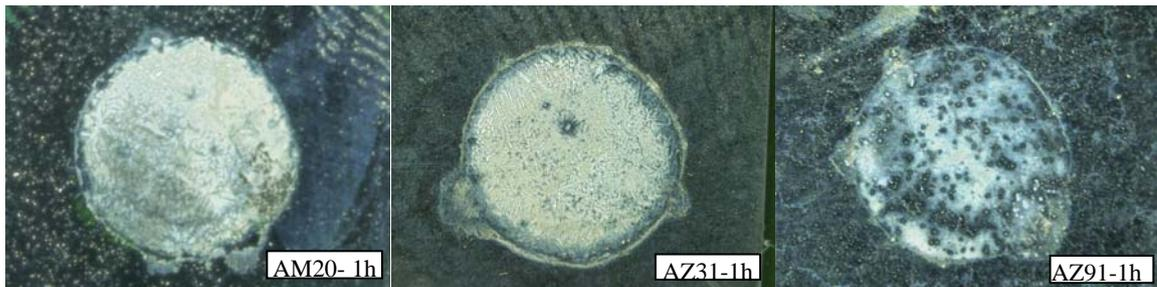
**Figura 3.2** Fotografías de las áreas de las aleaciones de magnesio AM20, AZ31 y AZ91 luego de 1 hora en el ensayo para las curvas de potencial de circuito abierto (OCP) en un electrolito de 0.1 Molar de NaCl.
