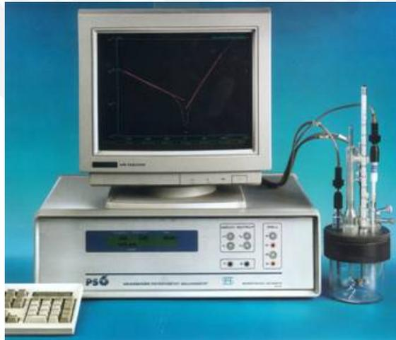
**Figura 2.1** Potenciómetro convencional usado en las pruebas electroquímicas
