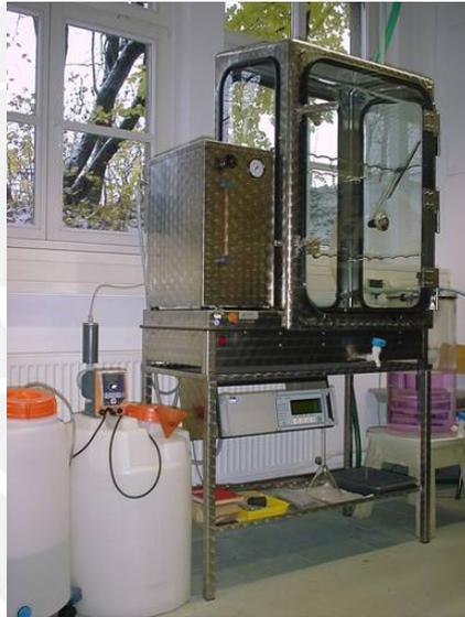
**Figura 2.2.** Cámara de neblina salada utilizada en el ensayo de rociado de sal en las aleaciones de magnesio.
