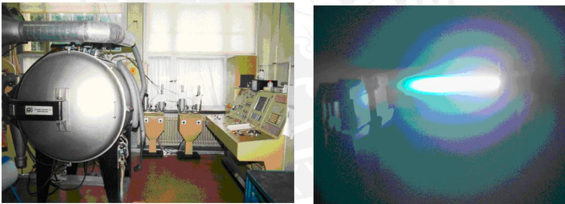
**Figura 3.26.** Rociado de plasma al vacío para partículas de SiC.
