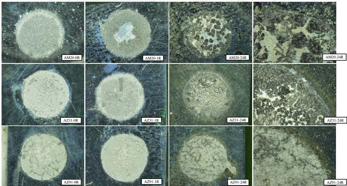
Figura 3.4 Curvas de polarización de las aleaciones de magnesio AZ31, AZ91 y AM20 en diversos tiempos de inmersión previo: 0,1 y 24 horas, mostrando además imágenes de las superficies de los materiales luego de cada ensayo de polarización.
