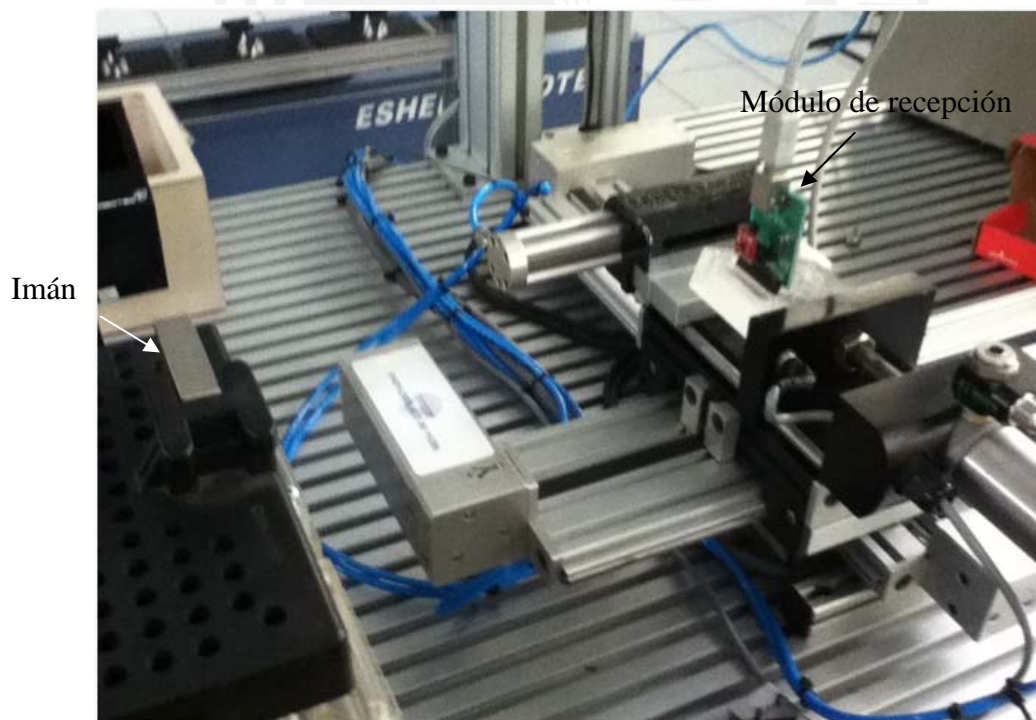
Figura 4.1: Instalación del sistema magnético en la mesa de coordenadas JIGXYZ del SCORA ER14
