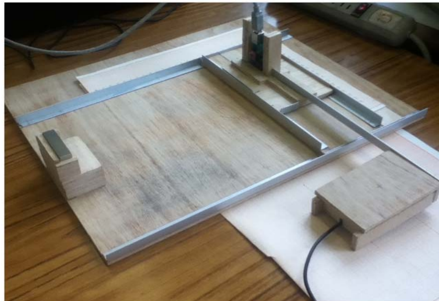
Figura 4.9: Instalación del sistema óptico y magnético en la maqueta de prueba
