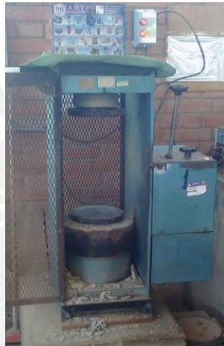
Foto4: Máquina de Ensayos a Compresión
