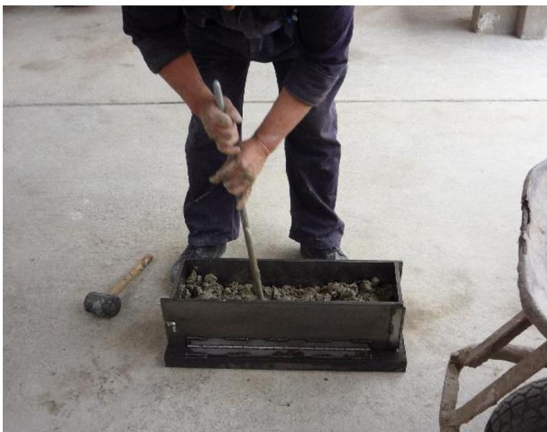
Foto5: Operario varillando la mezcla
