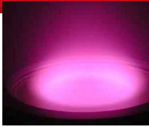
Figura 2.6. Plasma formado por Argón y la aplicación de voltaje [7]
