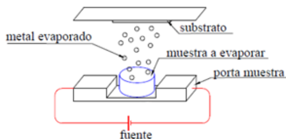
Figura 2.1. Representación del proceso de Evaporación [7]
