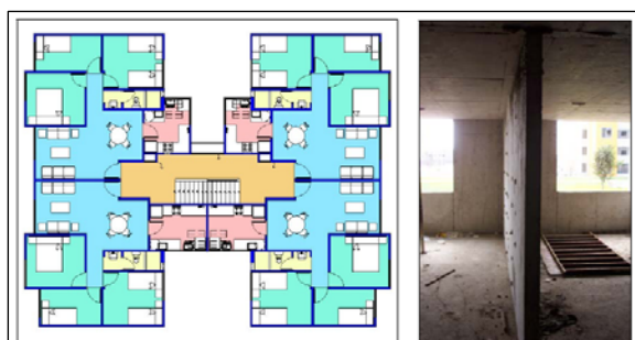
Figura 9.2.1 (b) Estructura de muros de concreto armado, departamentos de viviendas. ( www.pucp.edu.pe )
