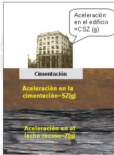
Figura 11.2 Izquierda: Mapa de zonificación sísmica y factores de zona Z . Derecha: Las aceleraciones en la roca, el suelo y el edificio, utilizando los parámetros de sitio. (NTE-030).
