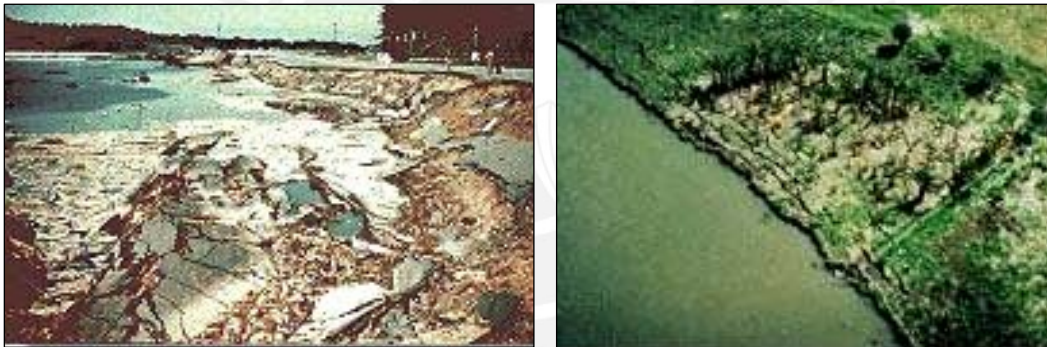
Figura 13.1 (e): Suelos susceptibles de licuefacción www.ce.washington.edu
