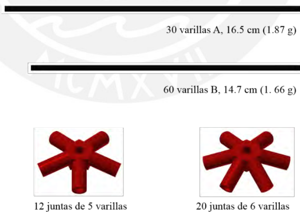
Figura 3.18: Varillas y juntas
