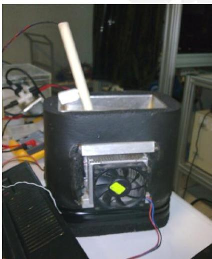
Figura 32. Baño térmico y sensor sumergible
