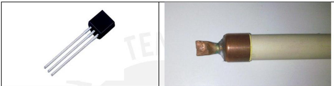
*Figura 7. A la izquierda Sensor de Temperatura Lm335, Fuente: revisar [13] – A la derecha Capucha de Sensor.*
