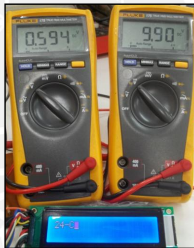
Fig. N°4.5.2.5. Voltaje de salida hacia los actuadores para una temperatura deseada de 24°C.
