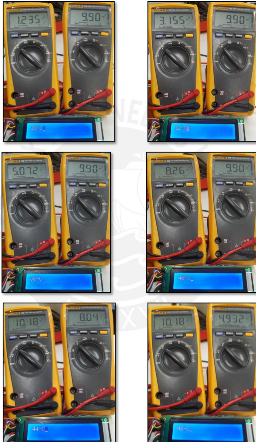
Fig. N°4.5.2.6. Variación del voltaje de salida según la temperatura deseada.
