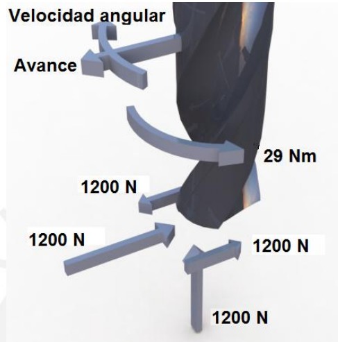
Figura 3.21: Descomposición de las fuerzas para el fresado frontal
