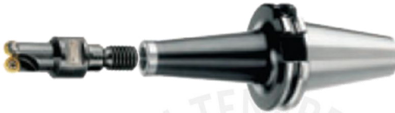
Figura 3.9.: Cono ISO 40 con extensión sólida y herramienta Coromill 300 24
