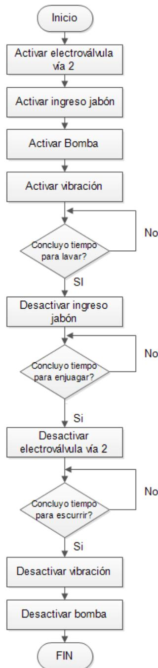
Figura 3 - 30: Diagrama de flujo del proceso 2
