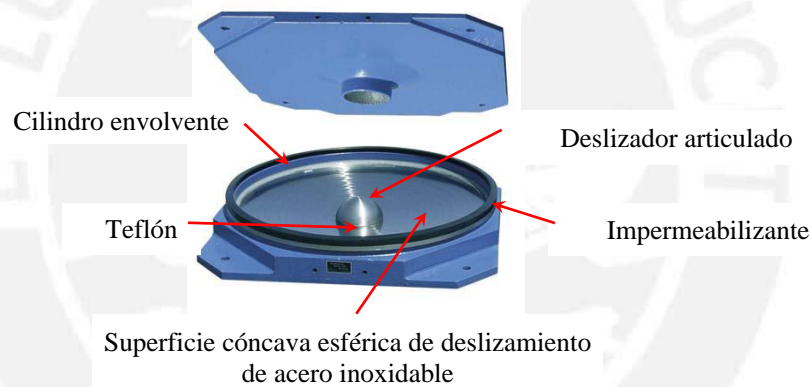
Figura 2.5 Aislador del tipo FPS.
