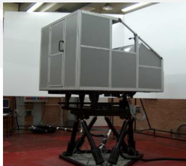
Figura 1.15 Cabina hecha con estructura de aluminio y láminas de policarbonato [Coiro, 2007]
