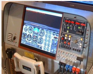
Fig. 1.9 Panel de instrumentos mostrados en una pantalla 5
