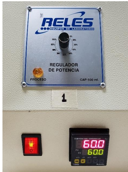
Figura 5. Sistema termostático estabilizado a 60°C
