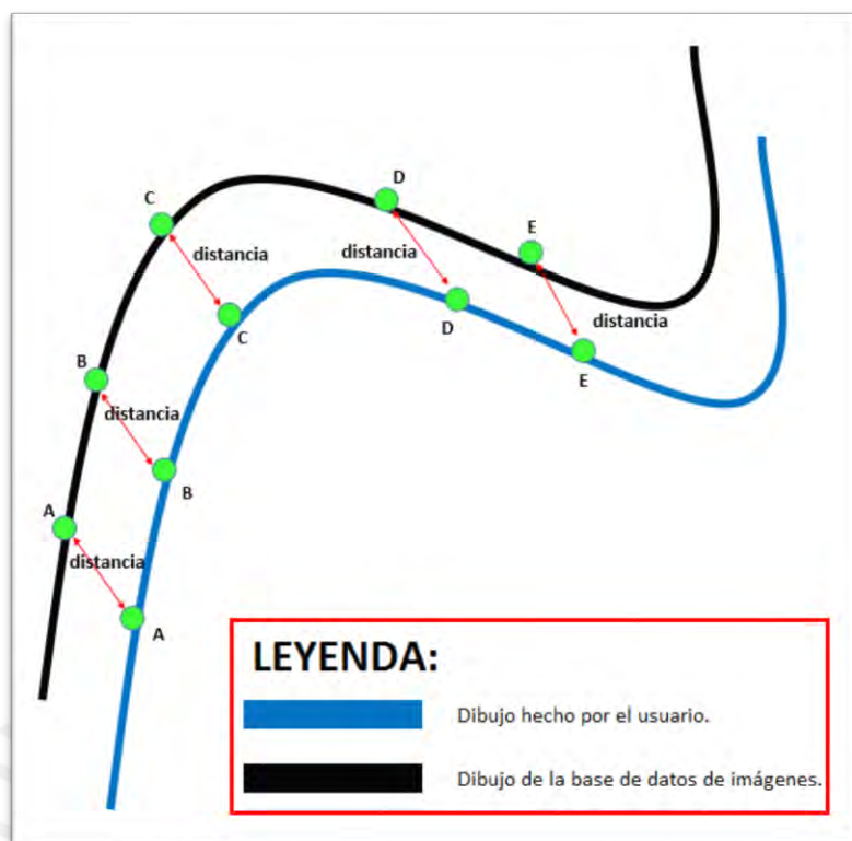
Imagen 39: Representación gráfica de la comparación a nivel de puntos de cruce A, B, C, D y E entre el dibujo hecho por el usuario y uno existente en la base de datos de imágenes (imagen de autoría propia).
