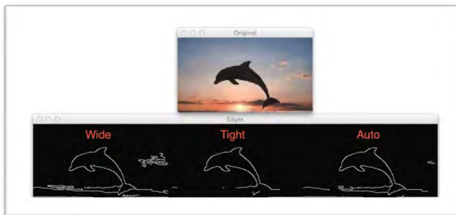
Imagen 3: Ejemplificación de la siluetización de una imagen (imagen obtenida del URL: http://www.pyimagesearch.com/2015/04/06/zero-parameter-automatic-canny-edge-detection-with-python-and-opencv/ ).
