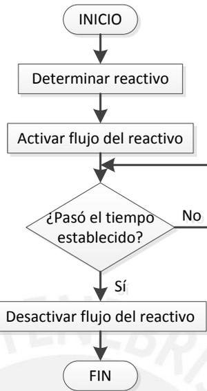
Figura 3.6.4.10: Diagrama de flujo de la subrutina Dispensado de reactivo.
