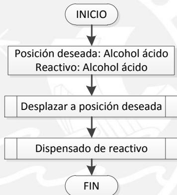
Figura 3.6.4.6: Diagrama de flujo de la subrutina Dispensar alcohol ácido.
