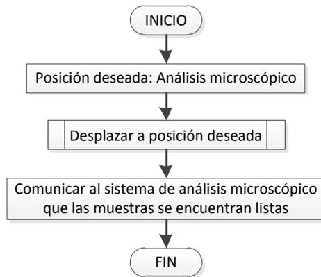
Figura 3.6.4.8: Diagrama de flujo de la subrutina Análisis microscópico.
