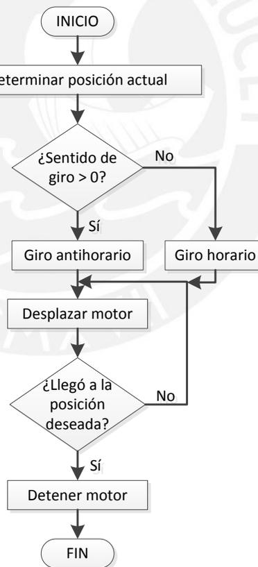
Figura 3.6.4.9: Diagrama de flujo de la subrutina Desplazar a posición deseada.
