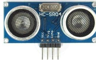
Fig. 3.5.1.3.2: Sensor de ultrasonido HCSR04
