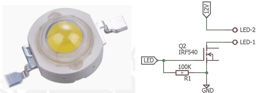
Figura 3.5.3.2.1: Diodo LED y diagrama esquemático de monitoreo del sistema.
