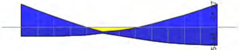
Figura 8.2: Demanda total de momento flector en la viga del sistema de aislamiento del tramo de viga VAIS-25
