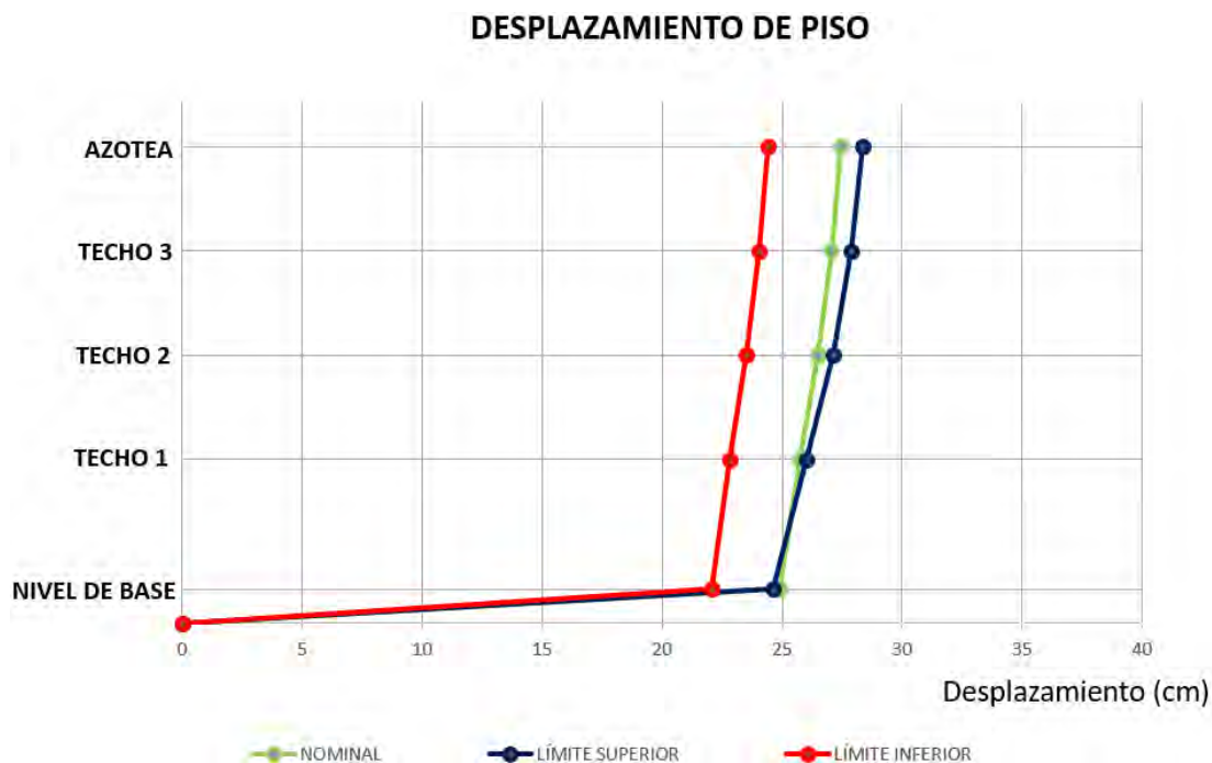
Figura 7.12: Demandas de desplazamientos en la dirección Y-Y
