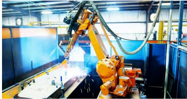
Figura 4: Brazo articulado - 6GDL, Fuente: ABB.com
