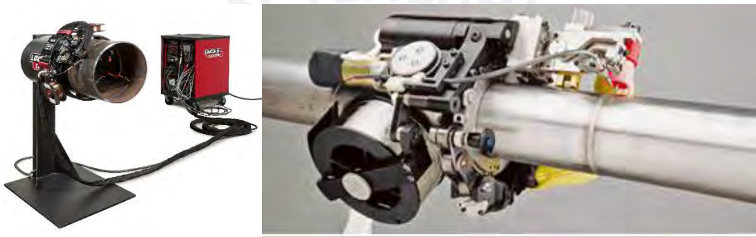
Figura 2: Vehículos (tractores) orbitales para soldadura de tubería, Fuente: Lincoln
