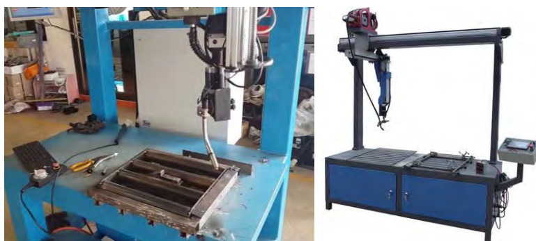
Figura 3: Mesas cartesianas CNC para soldadura, Fuente: Promotech.eu
