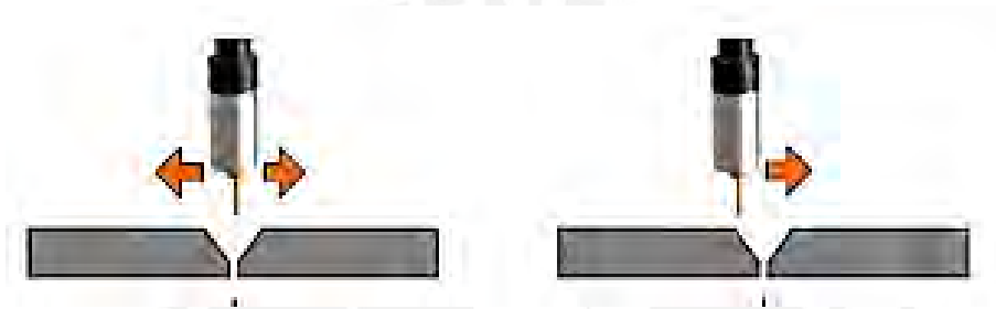
Figura 15: Seguimiento de junta por corrección, Fuente: http://www.robotwelding.co.uk/sensing-equipment-for-robots.html
