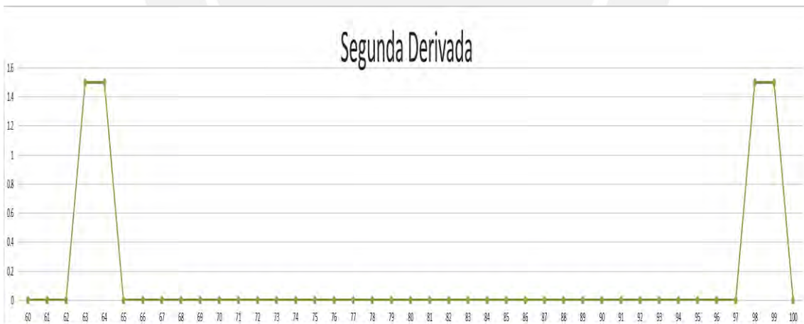
Figura 46: Diferencia de segundo orden de perfil de cordón soldado (segunda derivada)
