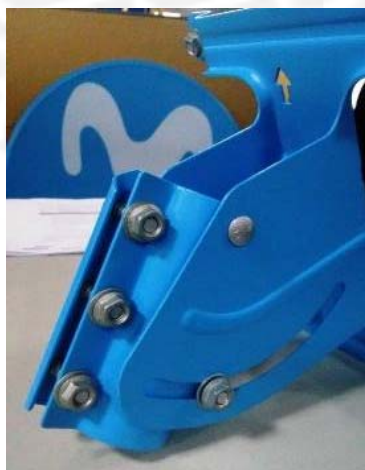
Figura 5. Fotografía Reforzamiento de abrazadera de mástil
