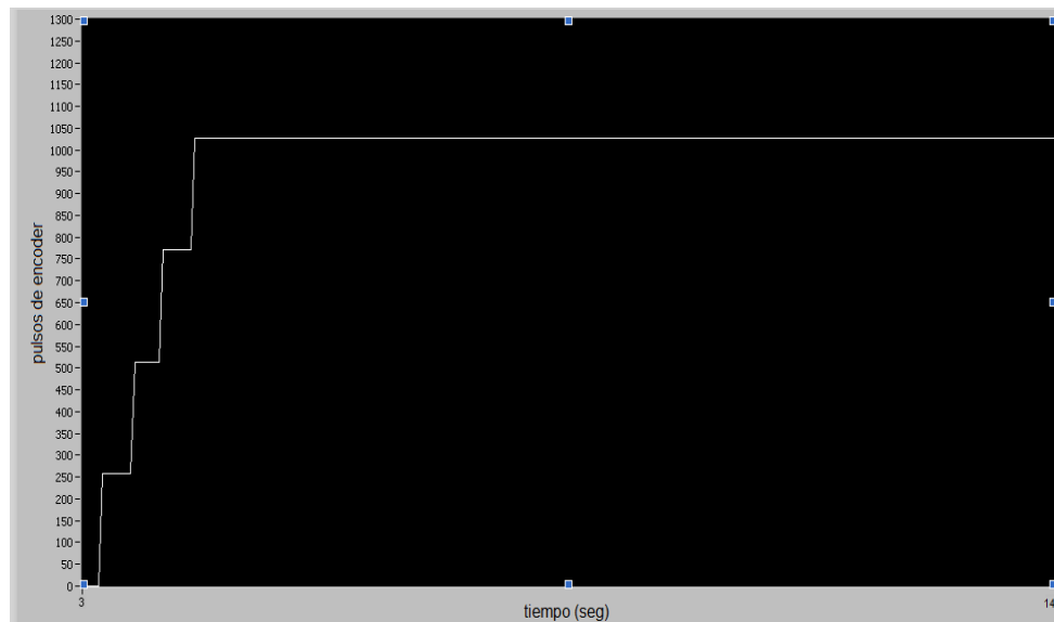
Figura 4.1.4: Respuesta del eje Y en lazo abierto (Condición de parada: 1028 pulsos del encoder)
