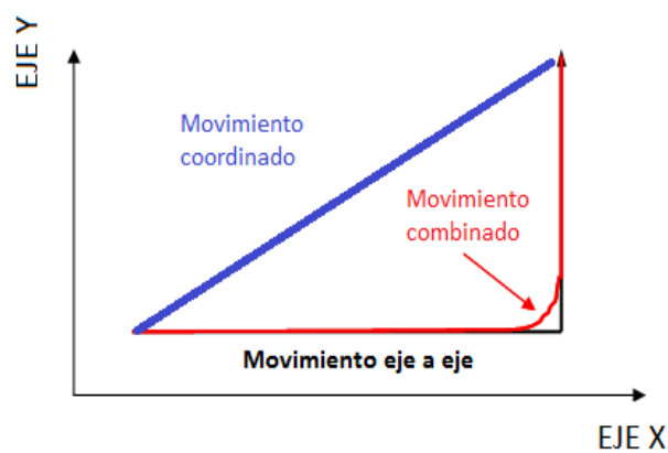
Figura 1.4.1: Trayectorias de movimiento eje a eje, coordinado y combinado
