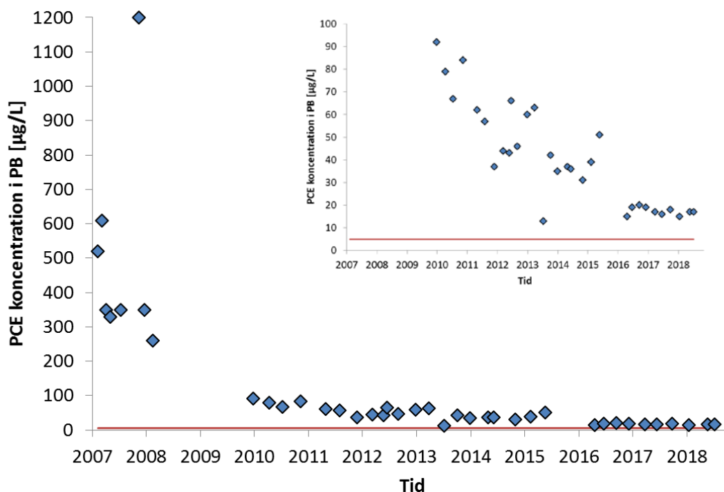
Figur 11 - Udviklingen i PCE-koncentrationen i vand fra afværgeboringen (PB) på Akacievej 2 over tid. Den røde linje repræsenterer stopkriteriet på 5 µg/L. Figuren i hjørnet er et zoom på koncentrationerne under 100 µg/L de sidste 8 år.
