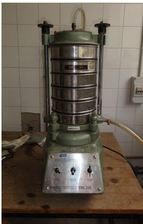
Figura 8. Garbellador HARVER (model EML 200) utilitzat per a les mesures de resistència dels agregats.
