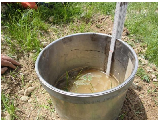
Figura 7. Detall de l'estructura muntada al camp per a realitzar les mesures d'infiltració.
