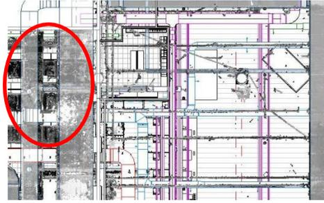
Se tiene que considerar que el nivel de techo baja en altura, debido a la presencia de conductos en el almacén. Afecta a la instalación de protección contraincendios.
