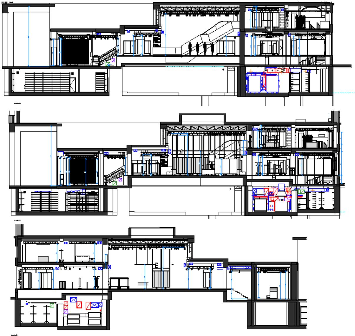
Figura 45 Vistas en sección obtenidas a partir de una representación del sub proyecto de arquitectura sobre una plataforma BIM como Revit(fuente: propia)
