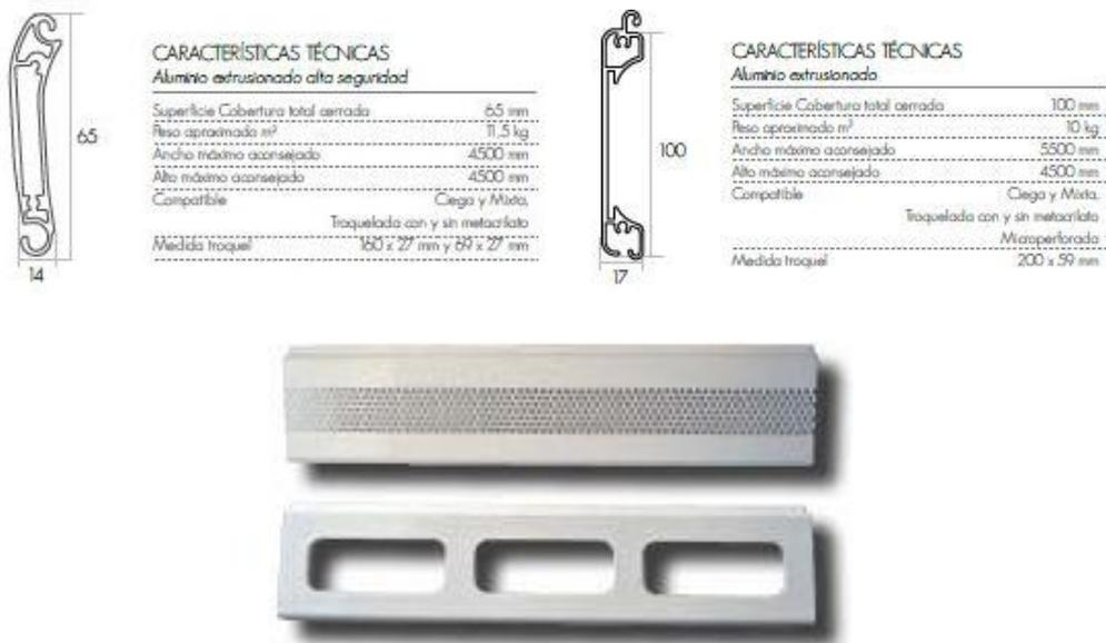
Figura 88 Lamas de seguridad rectas y curvas de extrusión de aluminio de la empresa Conetelec.
