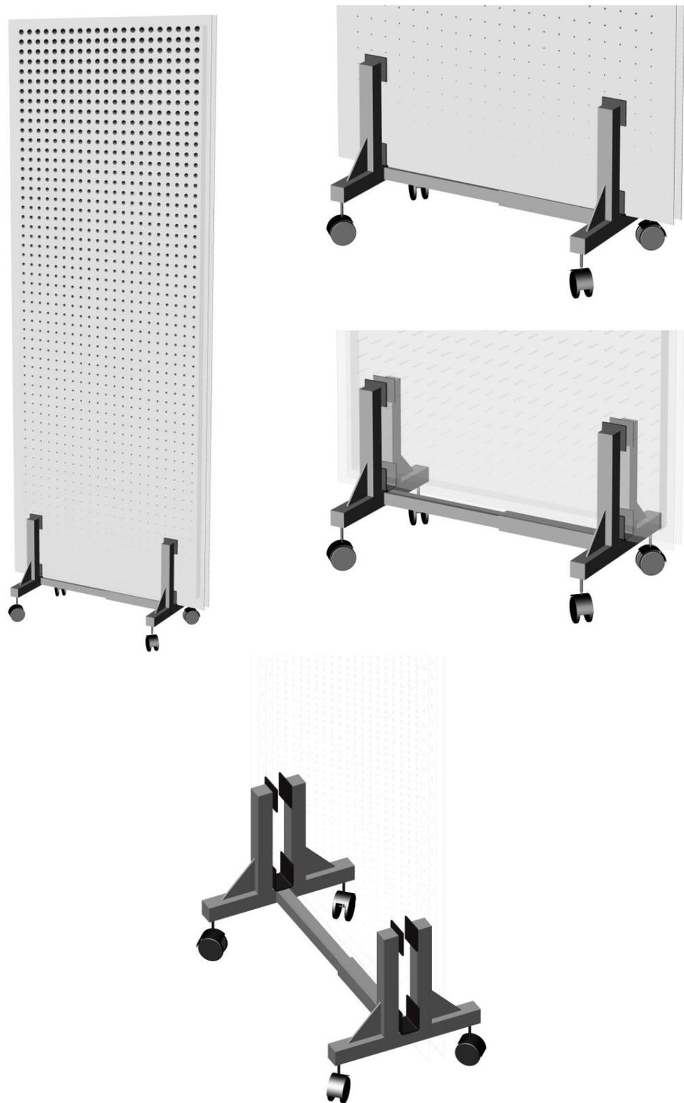
Figura 100 Modelo 3D de sistema de bastidor móvil para el montaje y el traslado de los plafones. (fuente: propia)
