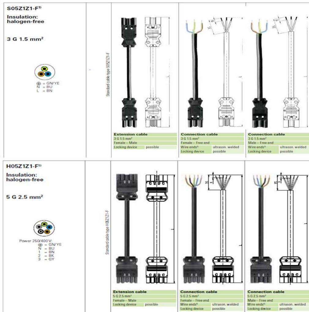
Figura 154 Componentes para uniones enchufables con conductores y terminales macho/hembra o terminales con conductores de 3 y 5 polos (fuente: [www.wieland-electric.com](http://www.wieland-electric.com))
