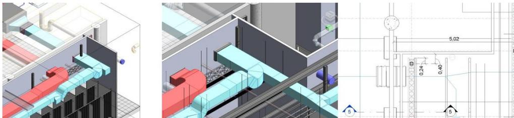
En la zona de probadores, el truss pierde la alineación de los anclajes. Esto permite resolver la colisión con el conducto de impulsión desplazando el nudo hacia la punta. Es conveniente, según conversación con Almacenes y Espacios Industriales
