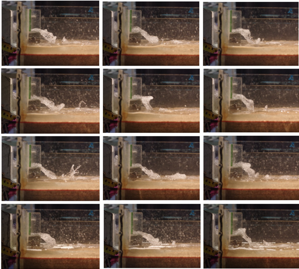
Figura 3.7 – Sequência de fotografias do jato obtidas num dos ensaios experimentais realizados ( \alpha = 20^\circ , Q = 0,71 L/s e h = 3 cm).
