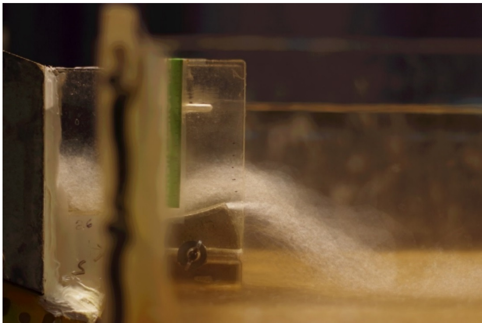
Figura 3.8 – Exemplo de uma imagem média do jato, obtida a partir das imagens representas na Figura 3.7, através do código escrito em Matlab ( \alpha = 20^\circ , Q = 0,71 L/s e h = 3 cm).
