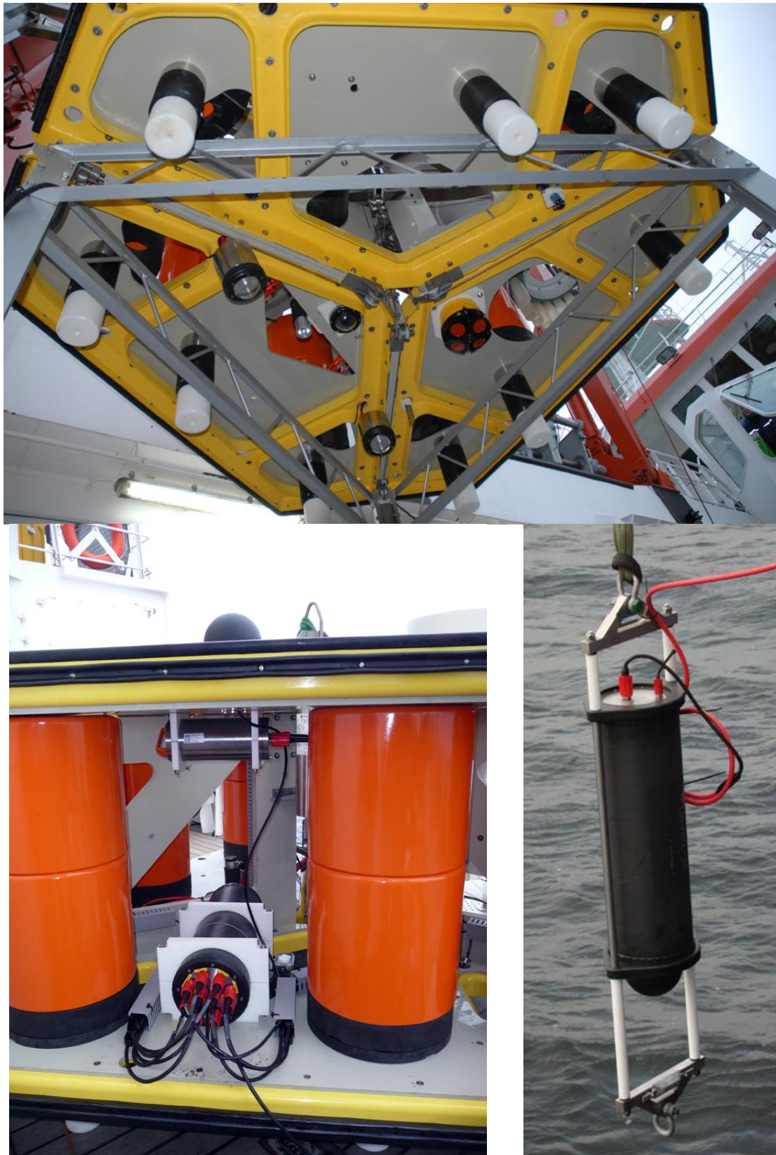
Abb. 5: Oben: Blick auf die Unterseite des Auftriebsmoduls nach Montage auf dem Dreibeingestell mit dem digitalen Kamerasystem, nach unten gerichteten 1200 kHz ADCP, Optode und pH-Sensor. Unten links: Zentrale Modemeinheit am MLM, darüber die autonome Steuerung der Sinkstofffalle. Unten rechts: Oberflächenmodem zur Kommunikation mit der Modemeinheit am MLM.
