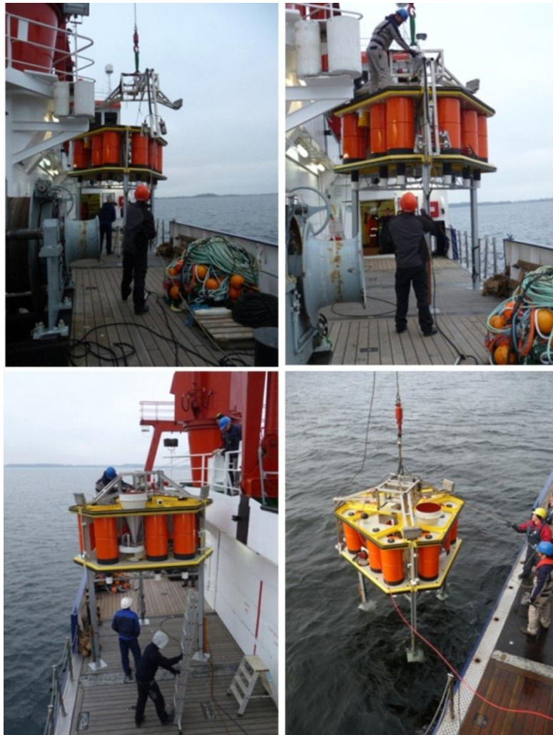
Abb. 14: Der Video-Absetzrahmen wird auf dem Masterlander Modul montiert, anschließend wird das MLM am VAR ausgebracht.
