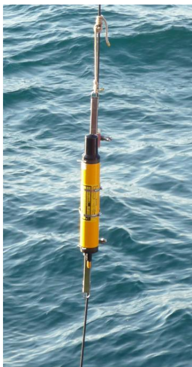
Abb. 13: Einsatz des USBL-Transponders am Draht über den geschleppten Systemen und fest integriert im ROV PHOCA.
