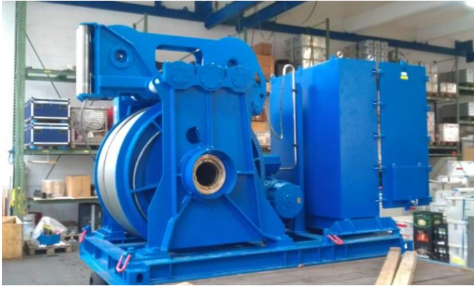
Abb. 17: links: die Winde für das ROV PHOCA; rechts: Aufbau des Versorgungskabels (Querschnitt).
