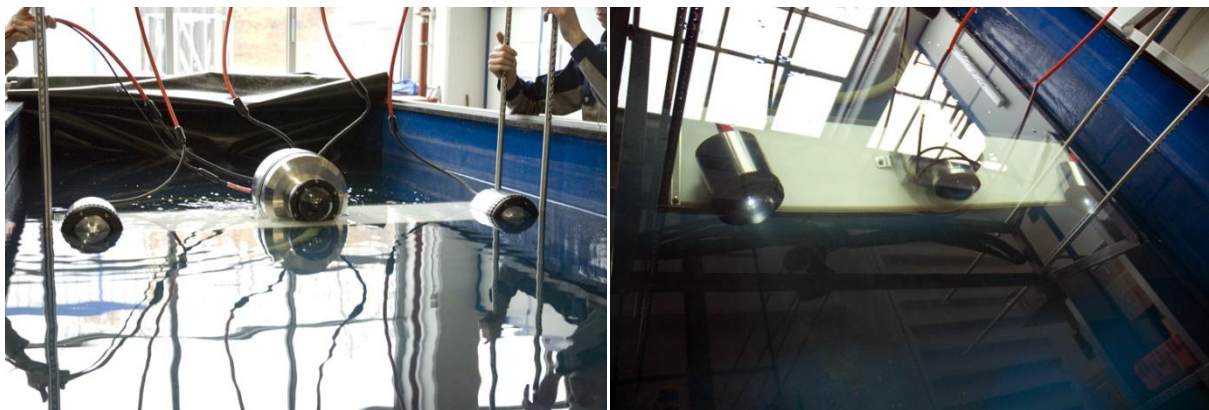
Abb. 3: Testeinsatz des Digitalkamerasystems im Tauchbecken des TLZ.
