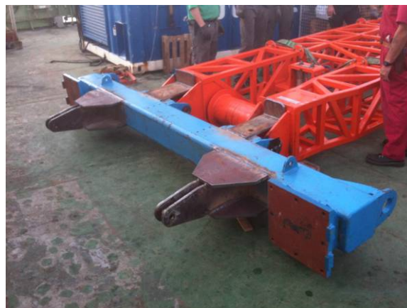
Abb. 4: Adaptertraverse (blau) mit neu-angeschweißten Blechen (braun) montiert mit dem LARS (rot)
