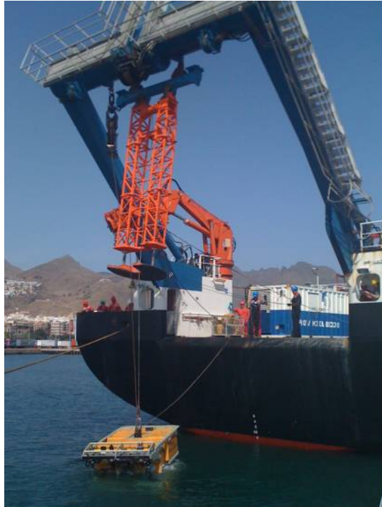
Abb. 5: ROV KIEL 6000 beim Absolvieren des Hafentests
