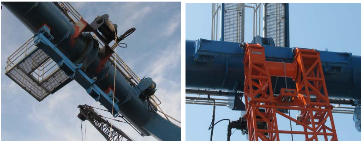
Abb. 3: die betroffenen Elemente in Natura, links Stellung A-Rahmen innen, ohne LARS, rechts außen mit LARS
