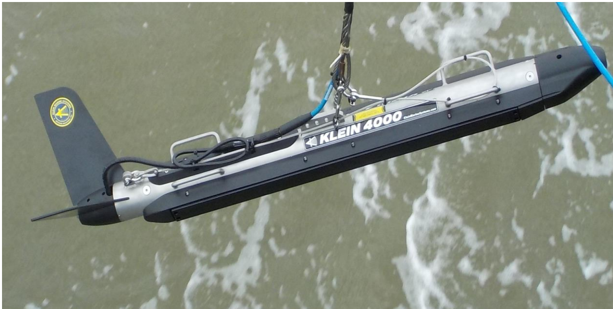
Abbildung 1: Schleppfisch des Klein System 4000 Sidescan Sonar. Dieses System sendet und empfängt simultan Signale mit Frequenzen von 100kHz und 400 kHz.
