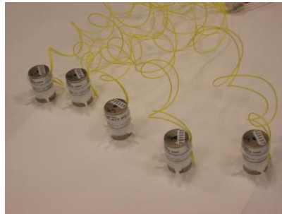
Figura 9. Fotografía de válvulas solenoide de tres vías
