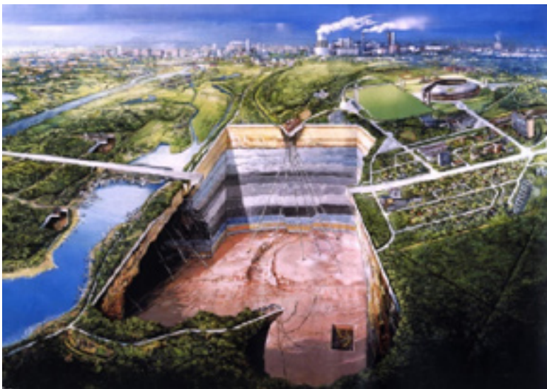
Querschnitt der verschiedenen Gesteinsschichten unter der Stadt im Bereich des Gasspeichers Ruhleben (BILD GASAG)
