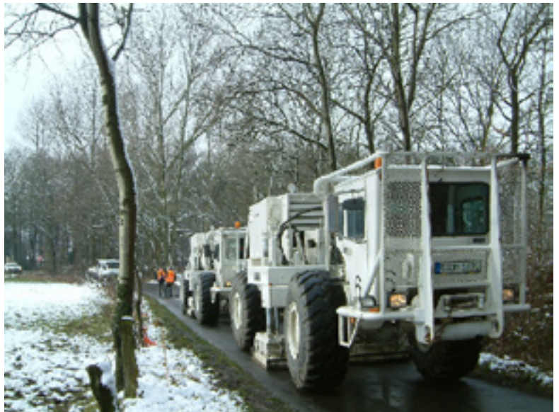
Kolonnen von Vibrationsfahrzeugen lassen die Erde leicht erzittern und erkunden mit geoseismischen Verfahren den Untergrund (Foto DMT GmbH)
