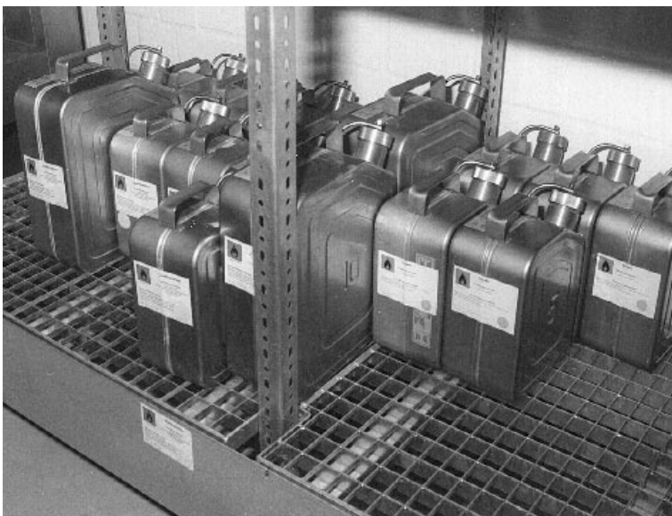
Ein Beitrag zum Grundwasserschutz: Lösemittellagerung in Spezialkanistern und auslaufgeschützten Regalen
