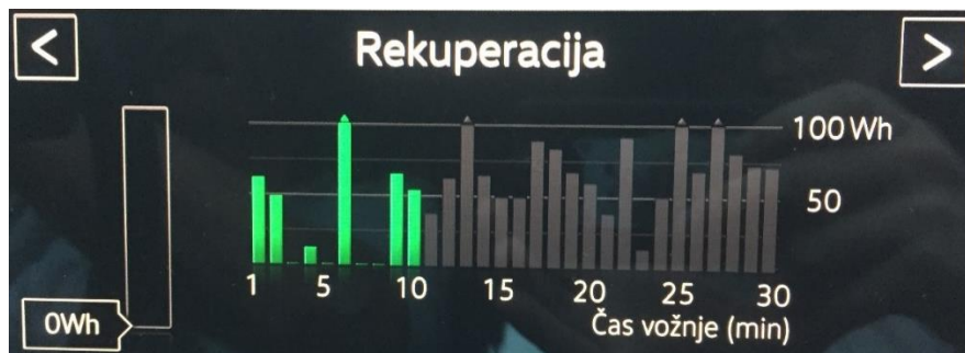
Slika 5.7: Prikaz rekuperacije oz. polnjenja baterije z zaviranjem (Vir: Lasten, oktober 2018)
