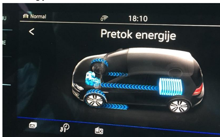
Slika 5.6: Prikaz pretoka energije na kolesa (Vir: Lasten, oktober 2018)
