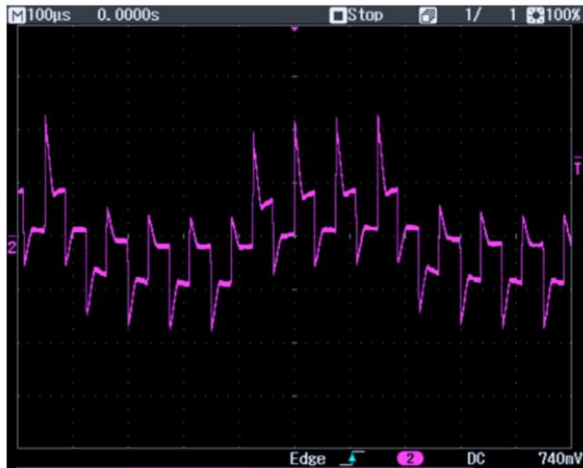
FIGURA 4.5: Tensione di alimentazione in uscita dall'AWADIT.
