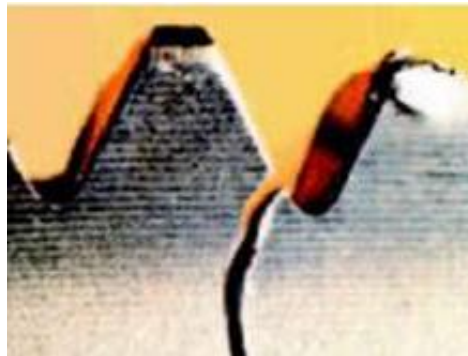
Figura 7.11: Exemple de fallida d'un engranatge al peu de la dent. Font: [17]
