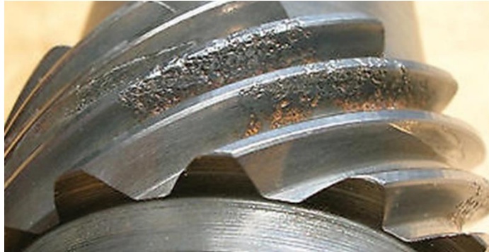
Figura 7.10: Exemple de fallida d'un engranatge degut a picat superficial. Font: [16]
