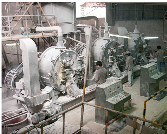
Photo 61. Hydrocyclone avant passage au flash-dryer dans une usine de production d'amidon, région de Nanning, Chine. (©Dominique Dufour, Cirad)
