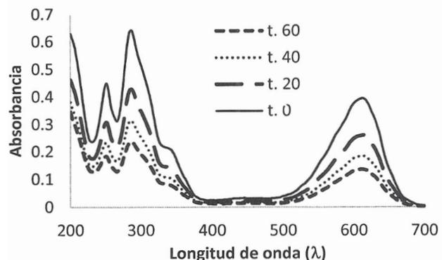
**Figura 4.** Evolución de los espectros UV-Vis de soluciones acuosas del colorante IC durante el tratamiento de EC.
