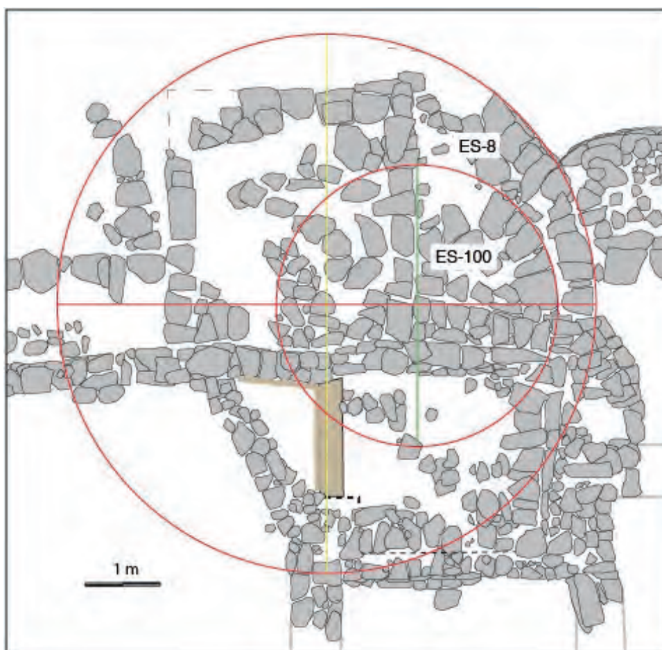
Figura 15. Reconstrucció del disseny geomètric de les estructures semicirculars bastides a l'angle format per les dues torres.
