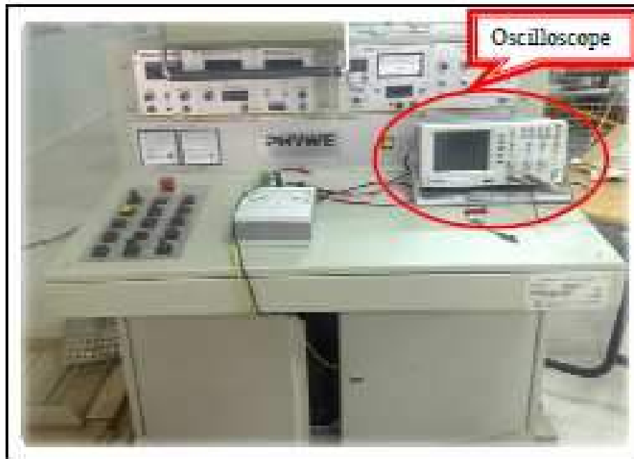
Photographie II.2 Photographie du pupitre de commande et oscilloscope numérique du laboratoire de haute tension de l'université de Biskra.
