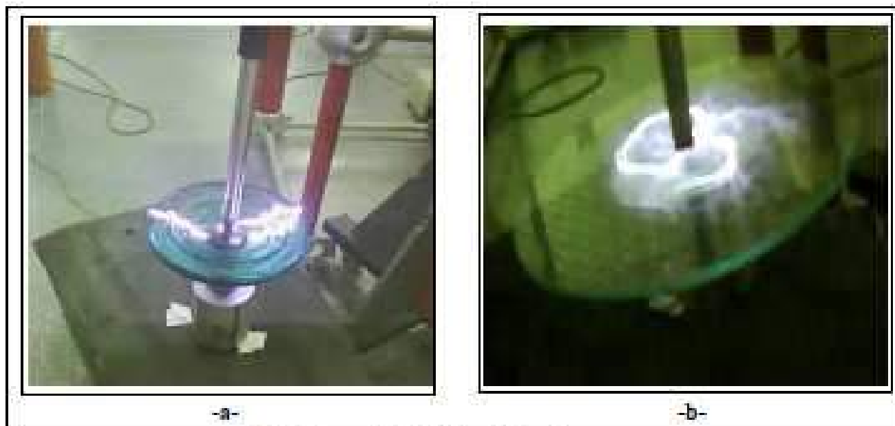
Photographie III.2 Evolution des arcs a- Modèle réel, b- Modèle expérimental.
