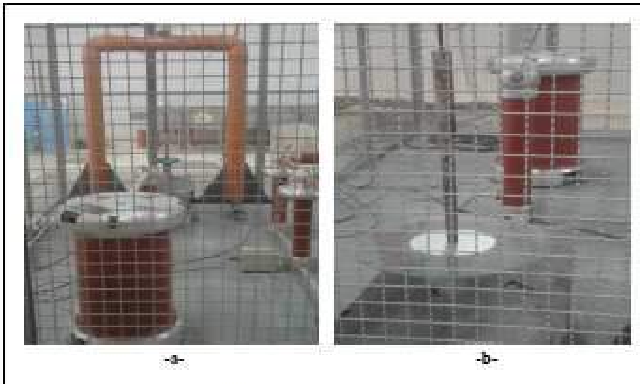
Photographie II.1 Circuit d'essai à fréquence industrielle. a-Modèle réel, b-Modèle expérimental.
