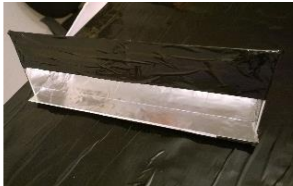
Figure 6.6 : La réalisation de la maquette. Etape 3 : La réalisation du plafond anidolique intégré (Source : Auteur)
