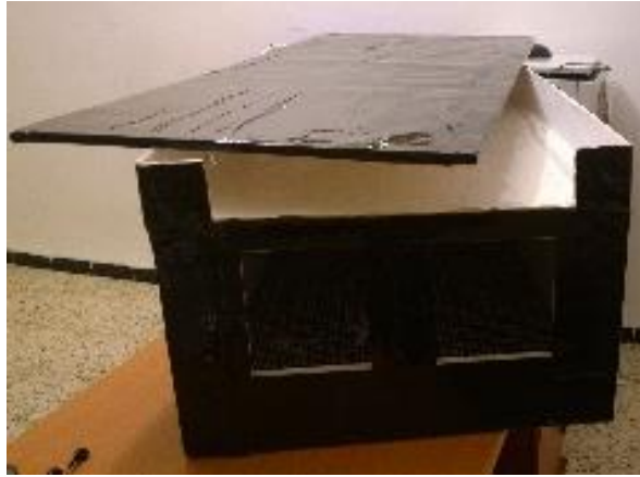
Figure 6.5 : La réalisation de la maquette. Etape 2 : La composition des parois, les recouvrir d'un autocollant noir et la réalisation du toit et du faux plafond (Source : Auteur)
