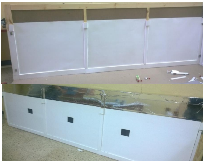
Figure 6.11 : Revêtement du grand côté du modèle physique (Source : Auteur)
