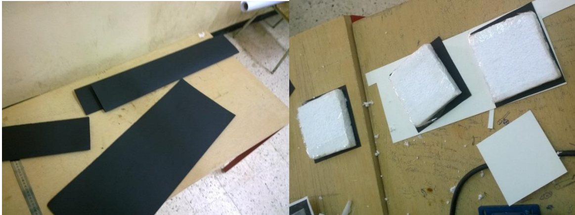
Figure 6.16 : Les matériaux utilisés pour l'étanchéité de la maquette à la lumière (Source : Auteur)
