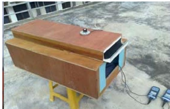
Figure 4.2 : Modèle physique construit en bois (Source : Roshan et al, 2013)
