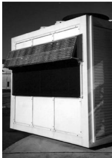
Figure 2.13. : Les stores solaires anidoliques (Source : Scartezzini et Courret, 2002)
