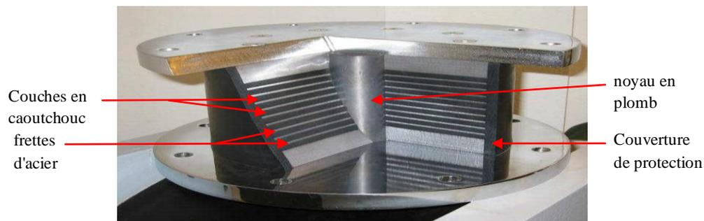
Figure 28 : Détails de l'appui en caoutchouc fretté avec barre de plomb
