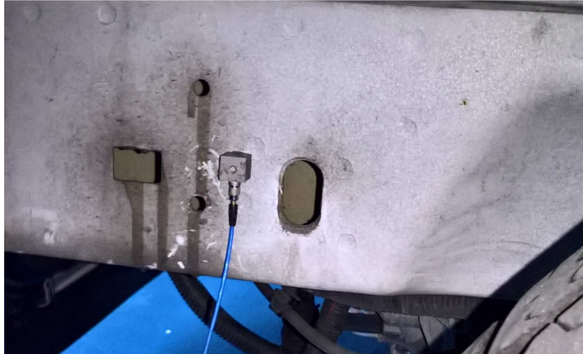
Abbildung 12: Messposition Karosserie Längsträger vorne in Fahrtrichtung links.
