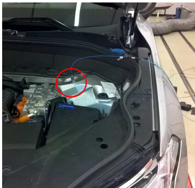
Abbildung 19: Anrege- bzw. Messposition Federbeindom vorne links.
