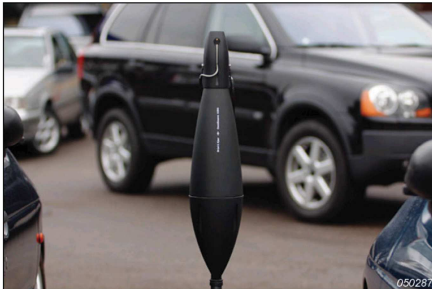
Abbildung 10: Brüel & Kjaer Omnisource mit Volume Velocity adaptor 14
