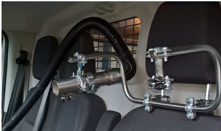
Abbildung 11: Anregeposition im Fahrzeug rechtes Fahrerohr
