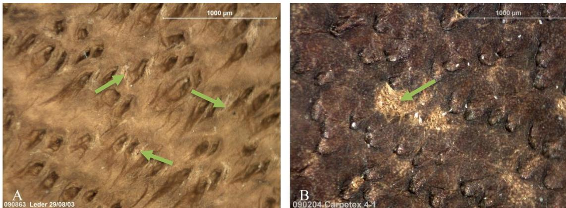
Abb. 74: Beschädigte Lederoberfläche [Carpetex Lederhilfsmittel GmbH et al., 2009]
