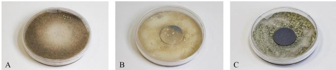
**Abb. 29: Beispiel eines vollständig (durch *Rhizopus oryzae*) (A), teilweisen (durch *Paecilomyces variotii*) (B) und nicht (mit *Eurotium amstelodami*) (C) bewachsenen Wet-Blue Prüflings**
