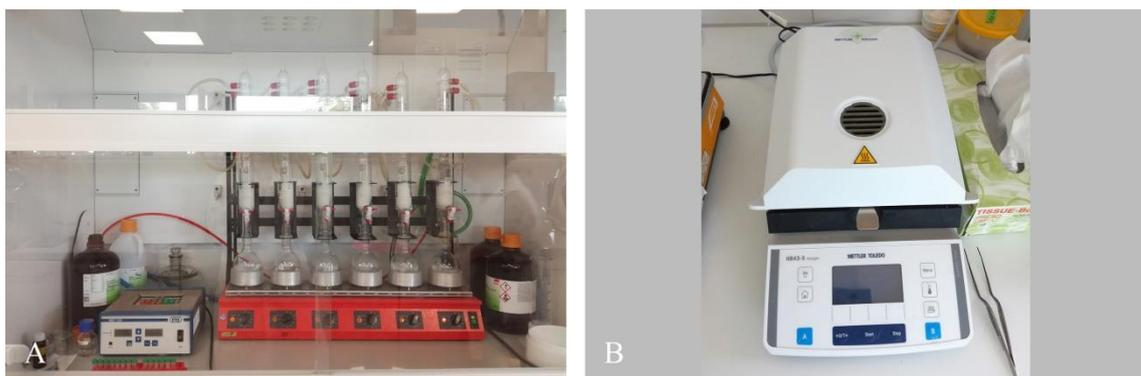
Abb. 28: Soxhlet- Apparatur (A) und Halogentrockner (B)
