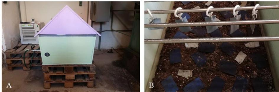
Abb. 27: Tropical Chamber-Test Außen (A) und Innen (B)
