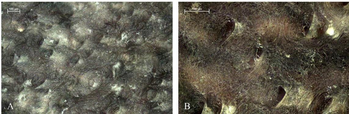
Abb. 83: Mikroskopische Aufnahme der mit *Aspergillus niger* DSM 1957 für 83 Tage kultivierten unterwachsenen Narbenseite von Wet-Blue bei 100-facher Vergrößerung (A) und 200-facher Vergrößerung (B), MS: 100 µm
