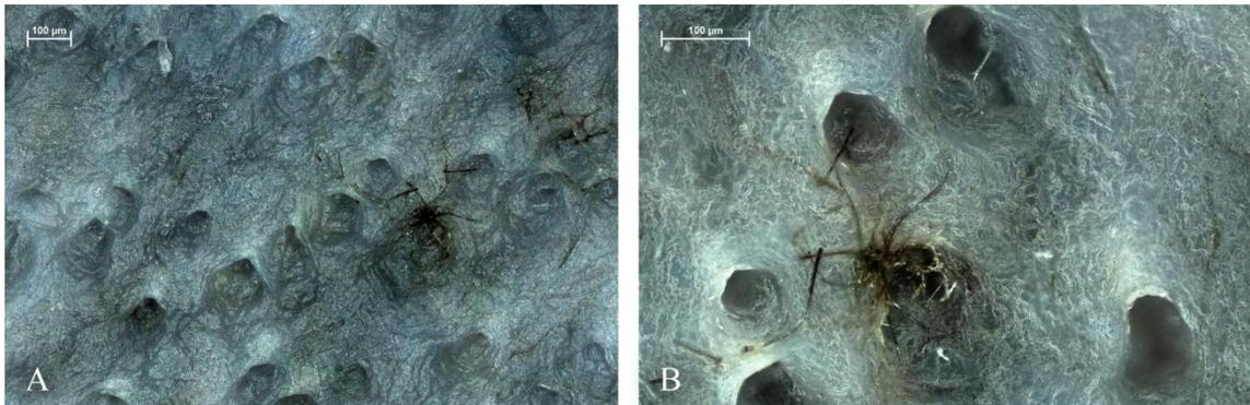
**Abb. 64:** Mikroskopische Aufnahme der mit *Hormoconis resiniae* für 104 Tage in der Feuchten Kammer kultivierten Narbenseite von Wet-Blue bei 100-facher Vergrößerung (A) und 200-facher Vergrößerung (B), MS: 100 µm
