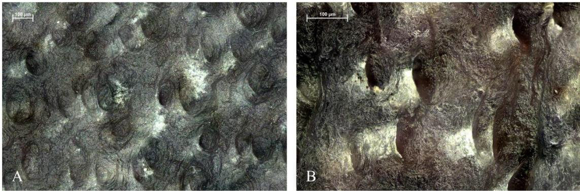
**Abb. 39:** Mikroskopische Aufnahme der mit *Aspergillus niger* DSM 1957 für 83 Tage im TEGEWA-Test kultivierten Narbenseite von Wet-Blue bei 100-facher Vergrößerung (A) und 200-facher Vergrößerung (B), MS: 100 µm
