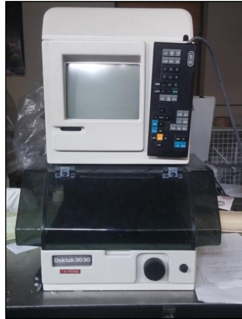
Bild 9 : Profilometer Dektak 3030 der Firma Sloan.
