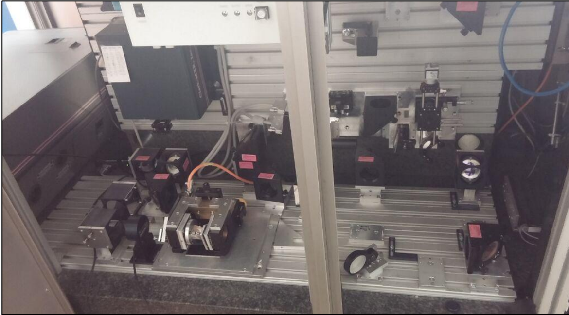
Bild 3 : erster Abschwächer und untere Strahlführungsebene.
