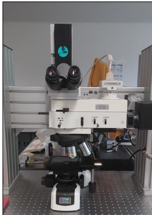
Bild 8 : Konfokalmikroskop der Firma Confovis.
