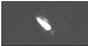
Bild 85 : Schweiß bei 240° Verdrehwinkel.
