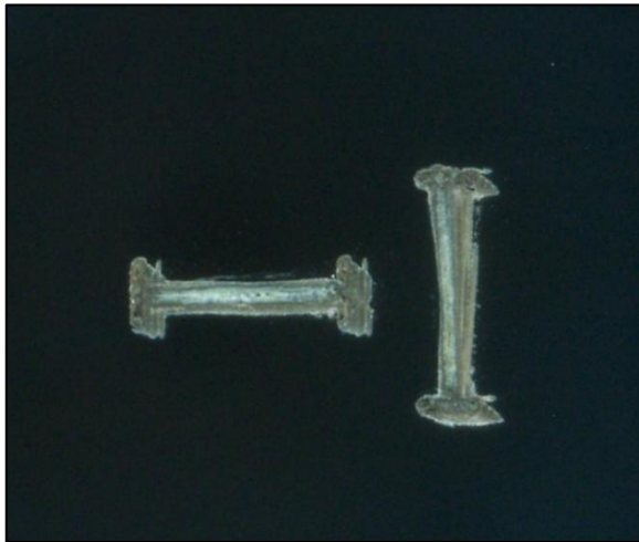
Bild 4 : Fokustest mit Strahlkaustik.
