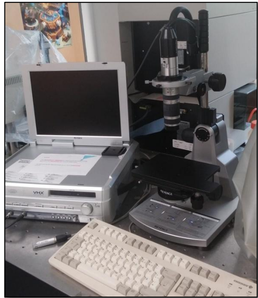
Bild 7: Lichtmikroskop der Firma Keyence.
