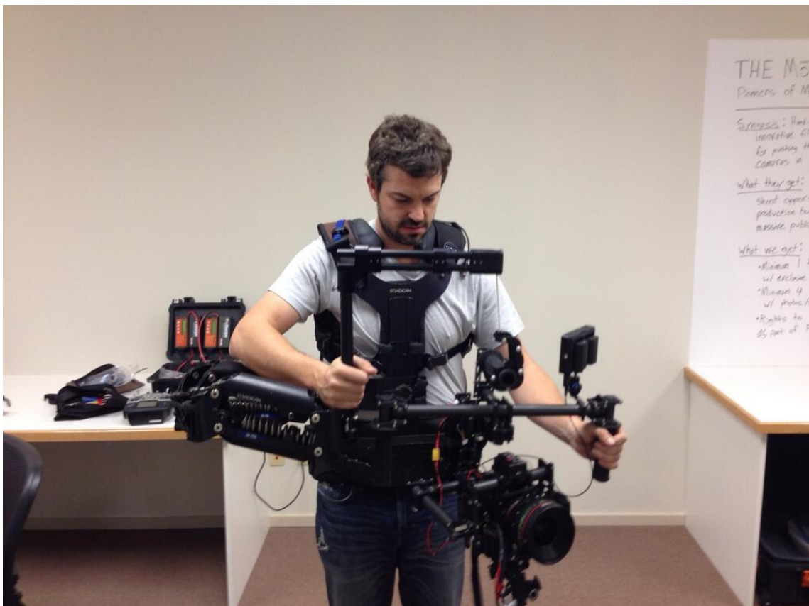
Abbildung 27: Kamera-Gimbal in Kombination mit dem Arm einer Steadicam
