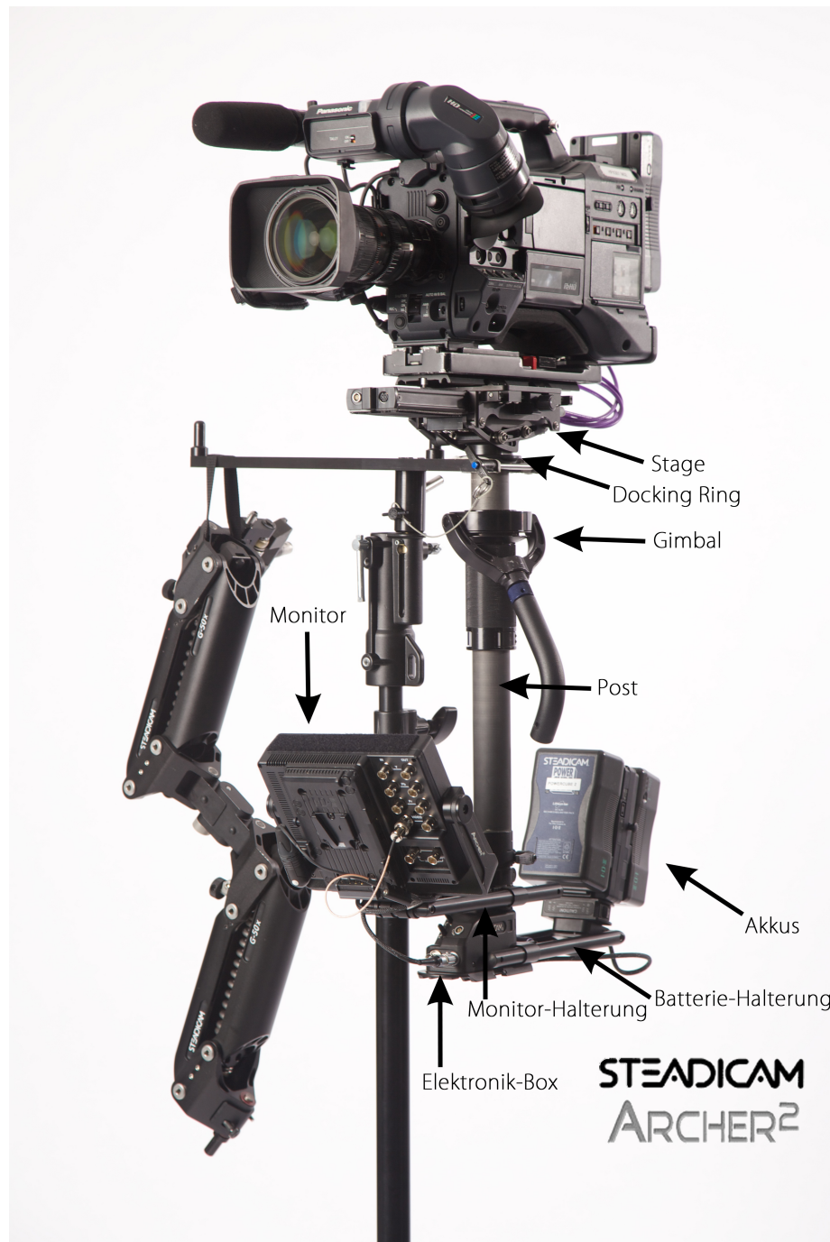
Abbildung 10: Die Komponenten eines Rigs am Beispiel der Steadicam Archer 2
