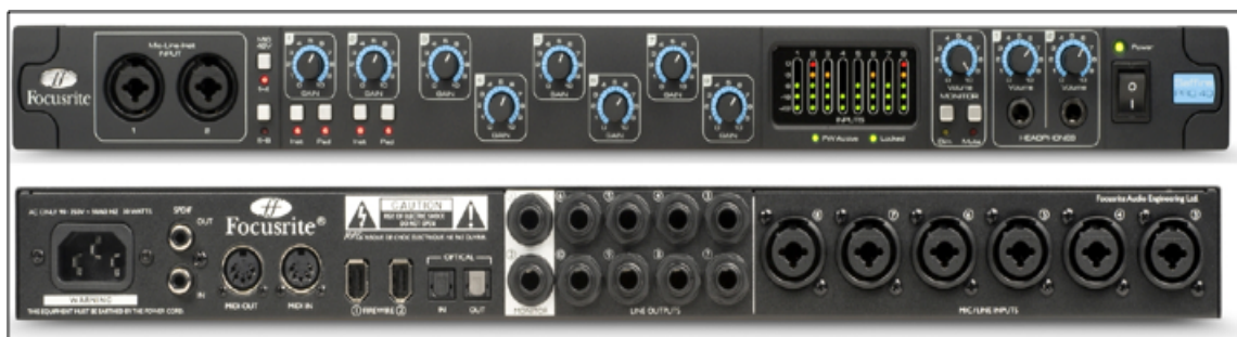
Abb. 12: Audio Interface mit Firewireanschluss (Modell: Focusrite Saffire Pro 40)
