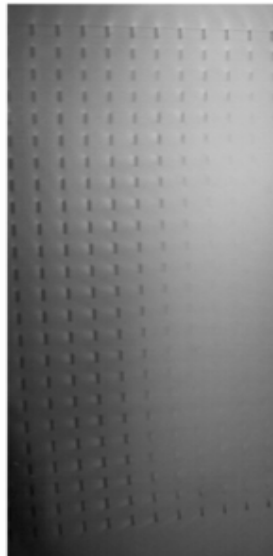
Abb. 3: Magnetlupenbild eines 2" 24 Spur Bandes
